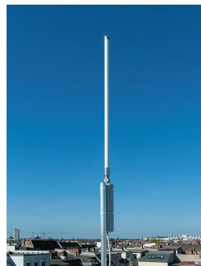
Gateway LoRaWAN para exteriores con alcance de hasta 15 km
