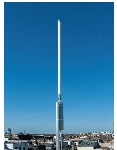
LoRaWAN-Outdoor-Antenne mit bis zu 15 km Reichweite
