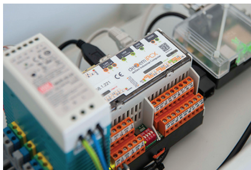
Datenlogger IPCX in Verteilerkasten
